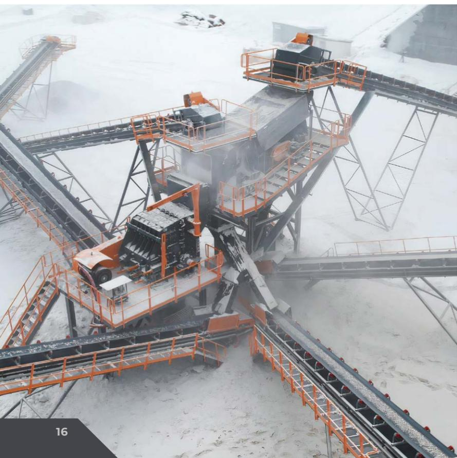
В роторной дробилке ударного действия измельчение породы происходит в результате механических ударов камней о быстродвигающийся массивный ротор с закрепленными билами, их взаимного соударения, ударов об отбойные плиты, а также под действием центробежных сил, в результате которых в кусках породы возникают напряжения, превышающие предел прочности при растяжении.
